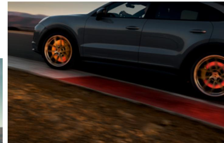
El sistema **Porsche Ceramic Composite Brake (PCCB)** ofrece una mayor potencia de freno en la carretera y en uso continuo en el circuito, gracias a sus discos cerámicos de 440 mm de diámetro en el eje delantero y 410 mm de diámetro en el eje trasero.
